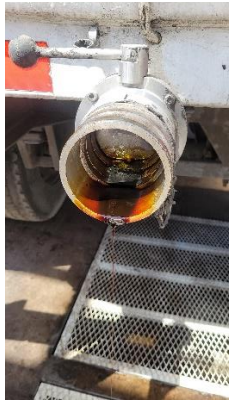
Camión Patente TSC 521: Melaza en válvulas inferiores
