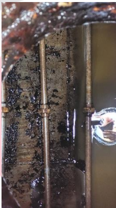
Camión Patente IOJ 503: Cisterna no apta para alimentos- Presencia de óxido y materia grasa.
