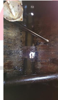
Camión Patente KKO 082: Cisterna no apta para alimentos- Presencia de óxido
